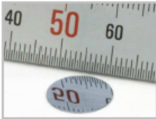
ハーフインチウエハ ( \Phi 12.5\text{mm} )
